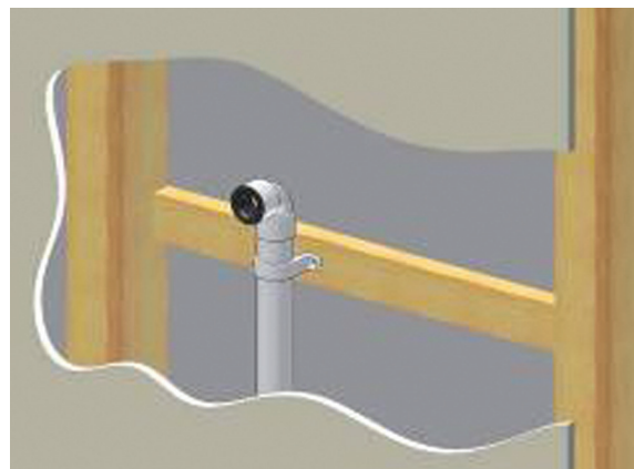
Obr. 15: Příprava připojení odvodu kondenzátu na svislý odpad
