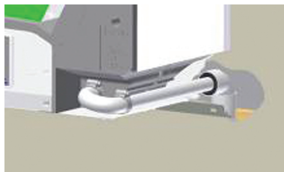
Obr. 17: Připojení trubky 22 mm na odpad
