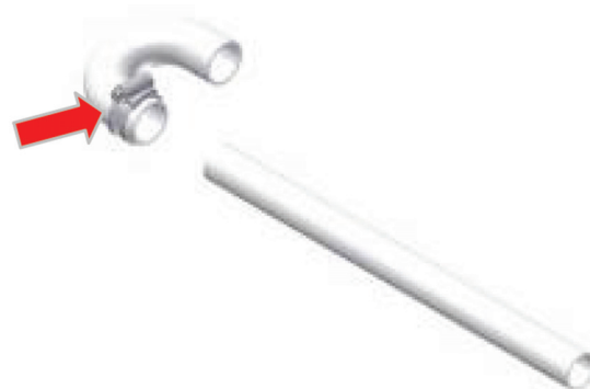
Obr. 16: Montáž hadice na kondenzát ve tvaru U
